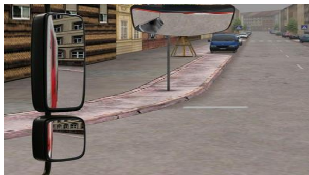
Rys. 7. Lusterka-Przykład zastosowania technik ONSCREEN "obraz w obrazie"
