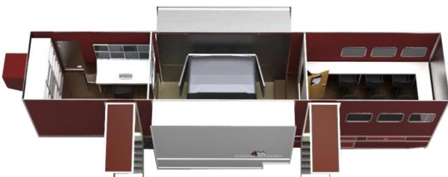
Rys. 4. Przykładowy rozkład pomieszczeń w naczepie symulatora mobilnego Źródło: Autocomp Management.
