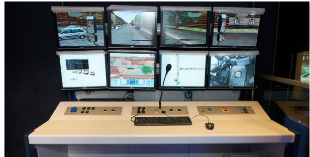
Rys. 9. Stanowisko instruktora w Mobilnym symulatorze jazdy samochodu ciężarowego i autobusu Źródło: Autocomp Management.
