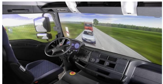
Rys. 5. Symulator ACM - Kabina samochodu ciężarowego z wielokanałowym systemem wizji typu ONSCREEN Źródło: Autocomp Management.
