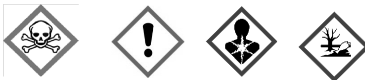
Rys. 1. Kody haseł ostrzegawczych: „Niebezpieczeństwo” (Dgr) i „Uwaga” (Wng). Piktogramy określone w rozporządzeniu WE nr 1272/2008 (CLP) mają czarny symbol na białym tle z czerwonym obramowaniem, na tyle szerokim, aby było wyraźnie widoczne
