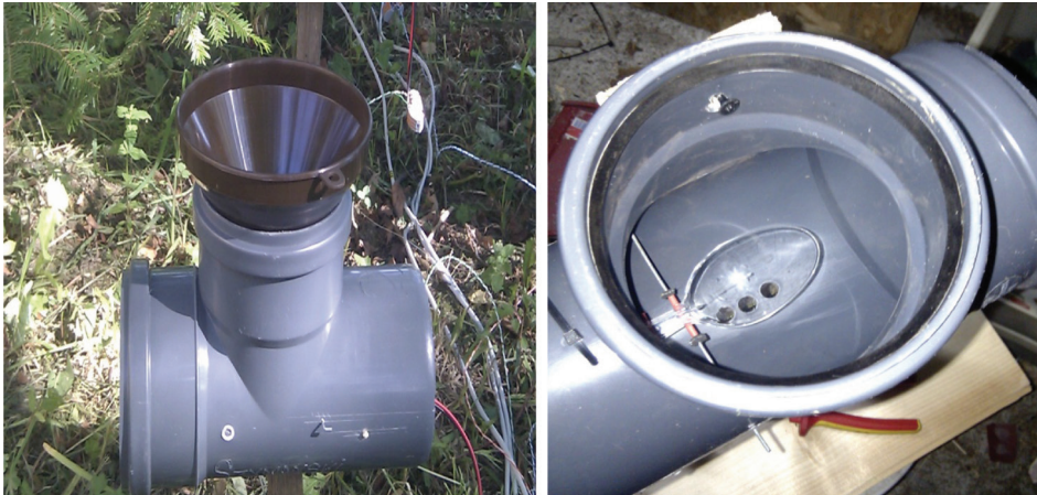
Rysunek 1. Deszczomierz typu „tipping bucket” z mechanizmem przechyłowo wywrotowy zamontowany w korpusie deszczomierza (Fot. Szymański W.)
