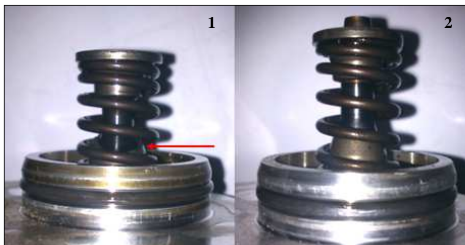
Rys.8. Uszkodzenie tulei prowadzącej tłok pompy: 1 – pęknięta tuleja prowadząca wraz ze startą końcówką tłoka pompy, 2 – nowy tłok pompy wraz z tuleją prowadzącą
