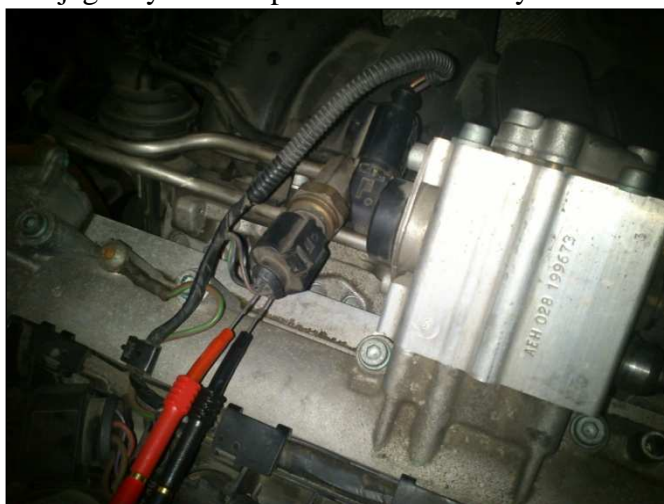
Rys.1. Sposób podłączenia sond pomiarowych oscyloskopu do czujnika ciśnienia paliwa w silnik FSI pojazdu VW Golf V
