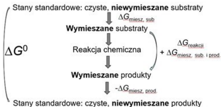
Rysunek 6. Schemat pokazujący efekty energetyczne mieszania reagentów na różnych etapach reakcji chemicznej, biegnącej modelowo od czystych substratów do czystych produktów w ich stanach standardowych
