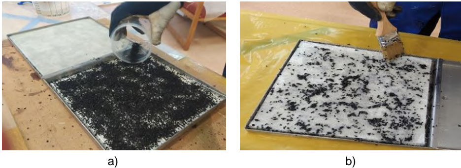
Rys. 1. Materiał kompozytowy z dodatkiem recyklatu: a) jako warstwy przekładkowej, b) jako dodatku do osnowy kompozytu
