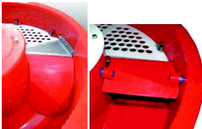
Rys. 13. Przegroda separacyjna w wygładzarkach wibracyjnych kołowych z dnem płaskim (a) i dnem wznoszącym (b)
