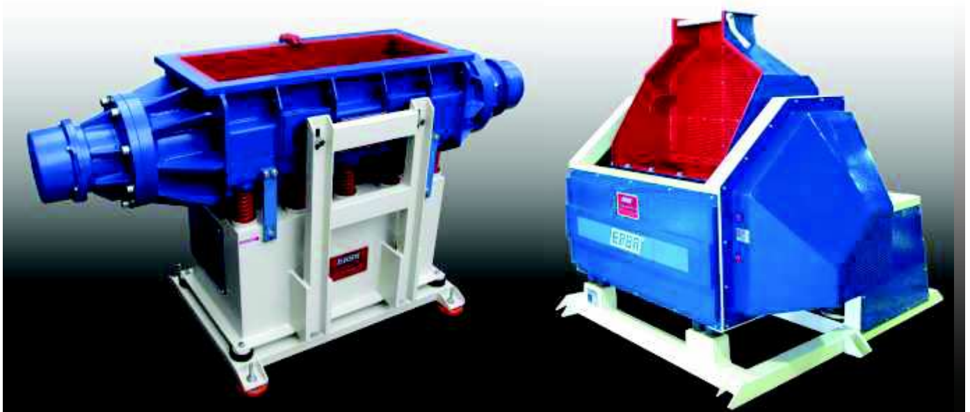
Rys. 14. Wygładzarki korytowe do polerowania naciskowego przy użyciu wsadów stalowych bez sita separacyjnego i z zewnętrznym sitem separacyjnym [9]
