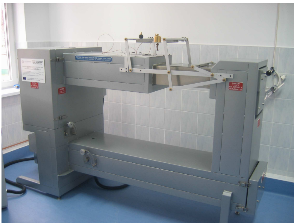
Fot. 2. Widok ogólny stanowiska do badań wskaźnika czasu zadziałania tryskaczy (RTI) oraz współczynnika przewodności (C)
