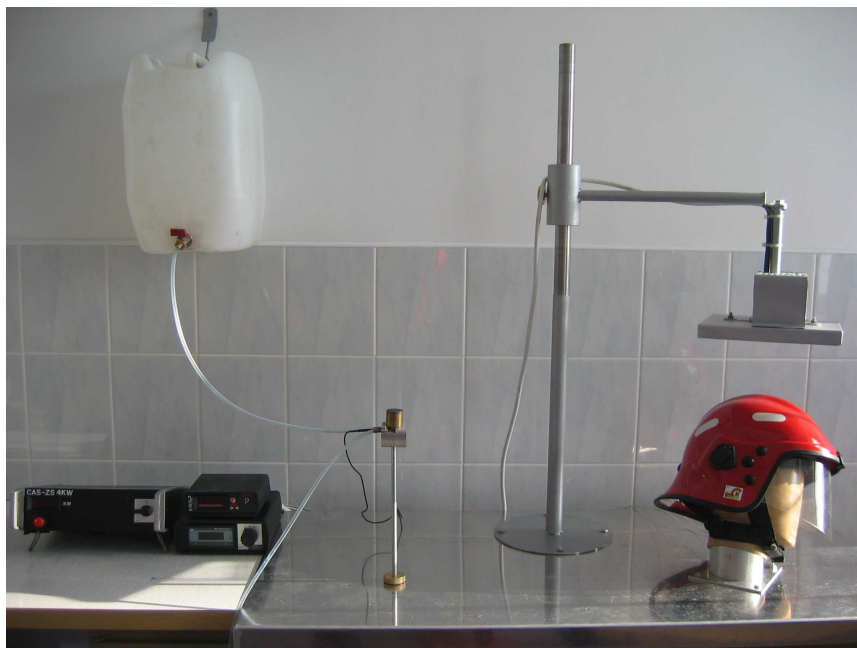
Fot. 5. Widok ogólny stanowiska do badania odporności hełmów strażackich na promieniowanie ciepłe
