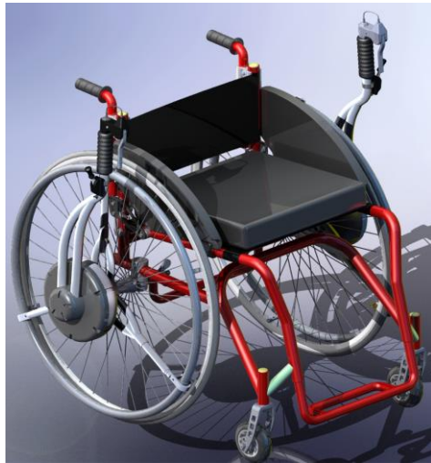
Rys. 8. Dźwigniowy system napędowy wózka inwalidzkiego
