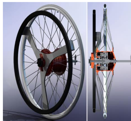
Rys. 7. Wielobiegowa piasta napędowa do ciągowych wózków inwalidzkich
