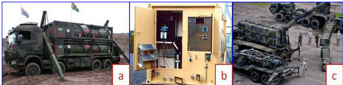
Rys. 3. Konteneryzacja, a) cysterna paliwowa w ramie o wymiarach kontenera, b) cysterna ze stacją do uzdatniania wody, c) pojemniki z uzbrojeniem w pakietach o wymiarach kontenerów [1]
