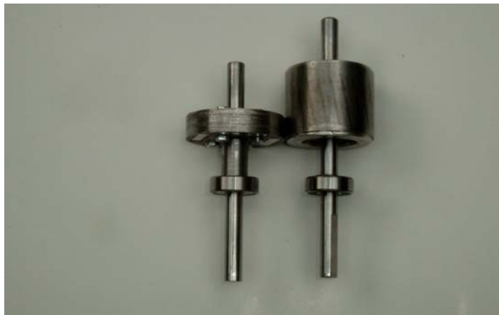
Rys. 9. Porównanie wirników nowego i dotychczasowego silnika
