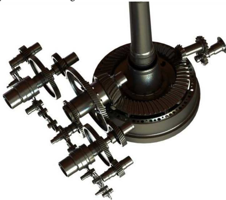
Rys. 8. Model ciągów kinematycznych przekładni głównej [2] Źródło: opracowanie własne na podstawie [2]
