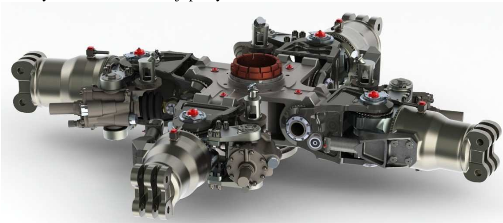
Rys. 1. Widok piasty wirnika nośnego: powyżej model 3D [6], poniżej rzeczywisty zespół piasty
