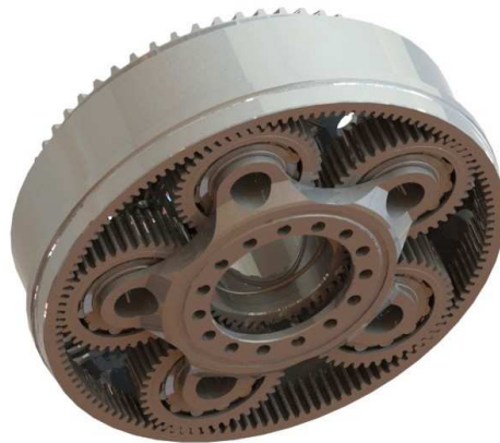
Rys. 5. Model 3D czwartego stopnia planetarnego przekładni głównej [2]
