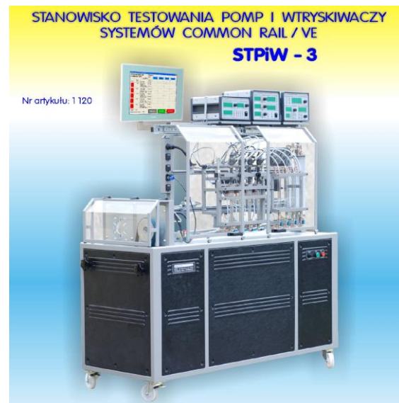
Rys. 1. Stanowisko testowania pomp i wtryskiwaczy systemów common rail i TDI
