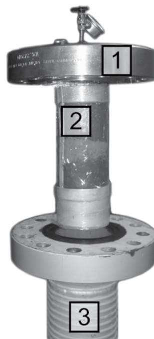
Fig. 4. Widok urządzenia RK 1 oraz modelu przed instalacją w komorze reakcyjnej
