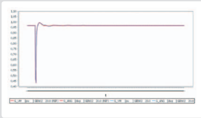
Rys. 6. Przebieg napięcia na zaciskach generatora uzyskany dla parametrów dynamicznych ekwiwalentu, wyznaczonych przez algorytm genetyczny (krzywa niebieska), w porównaniu z przebiegiem wzorcowym (krzywa czerwona)
