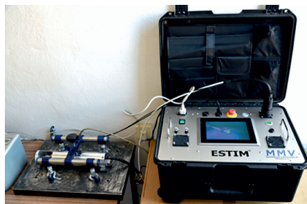
Rys. 1. Urządzenie SSSM podłączone do jednostki sterującej Fig. 1. SSSM device connected to the control unit
