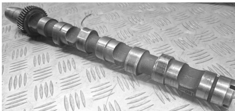
Rys. 4. Wałek rozrządu odlewany
