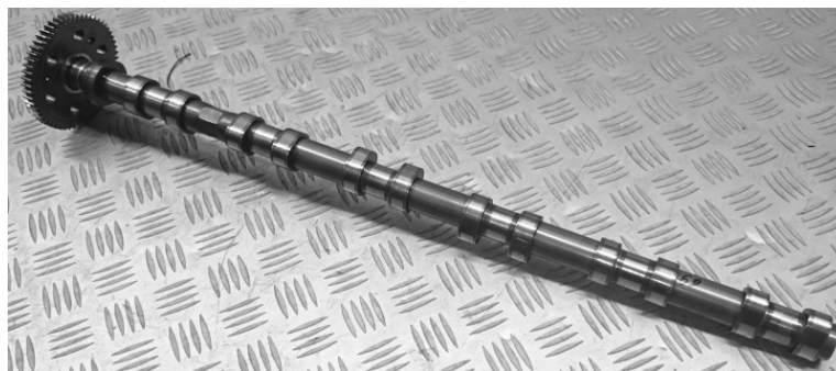
Rys. 9. Wałek rozrządu wykonany metodą hydroformingu
