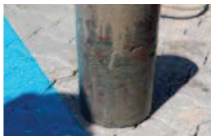
Rys. 7. Przykładowy rdzeń odwiertu MZC C16/20
