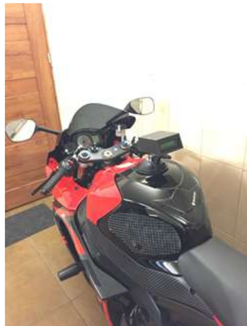
Rys. 2. Sposób zamocowania XL Meter Pro na badanych pojazdach
