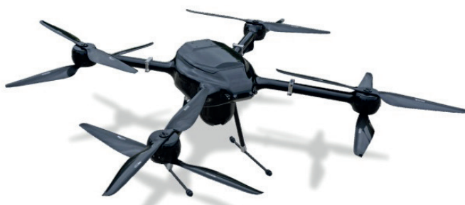
Rycina 10. Bezzałogowy statek powietrzny (mini-BSP) Atrax
