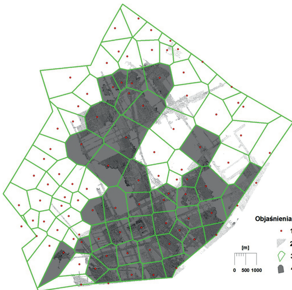
Rys. 2. Lokalizacja punktów opróbowania złoża Sierszowice na tle wieloboków Bołdyriewa Objaśnienia: 1 – otwór wiertniczy, 2 – stanowisko opróbowania złoża w wyrobiskach górnichich, 3 – wielobok Bołdyriewa, 4 – wielobok Bołdyriewa objęty eksploatacją złoża w blisko 50% jego powierzchni
