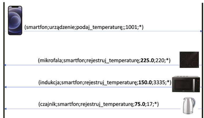
Rys. 4. Przykładowe raportowanie aktualnej temperatury przez urządzenia (zachowano bazową strukturę ramki, gwiazdką oznaczono nieistotną sumę kontrolną)
