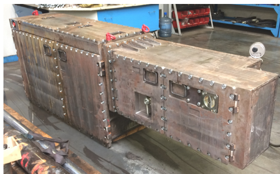
Rys. 3. Oslona przeciwwybuchowa układu zasilająco-sterującego [7]
