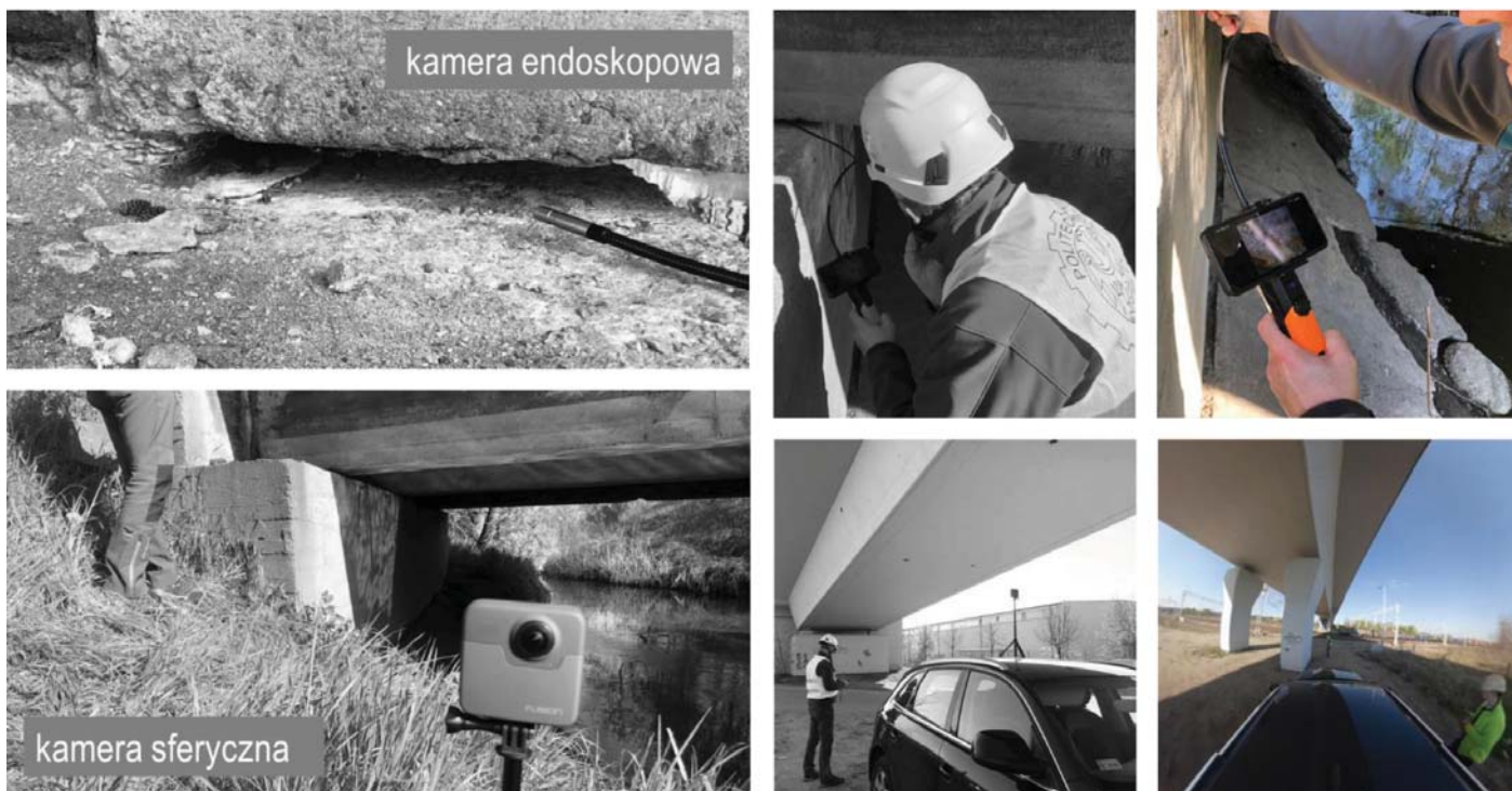
Rys. 13. Testy kamery endoskopowej i sferycznej podłączonych bezprzewodowo do urządzenia bazowego (materiały własne)
