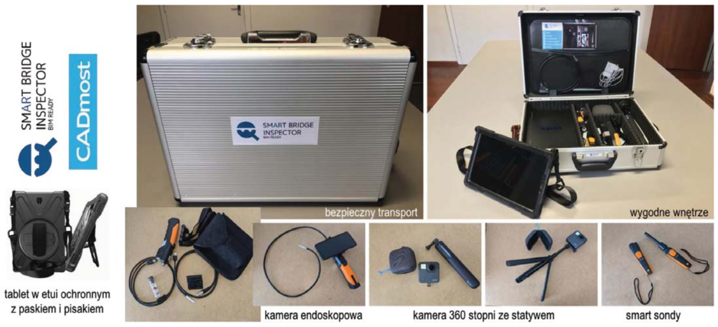
Rys. 11. Skrzynka inspektora mostowego z urządzeniem bazowym i dodatkowym wyposażeniem (materiały własne)
