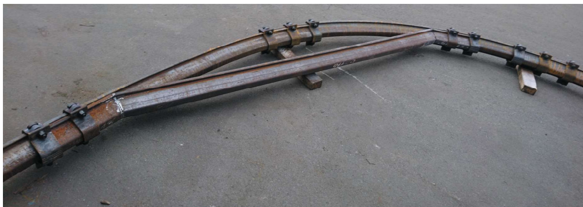
Rys. 7. Element wzmacniający w trakcie próbnego montażu u producenta
