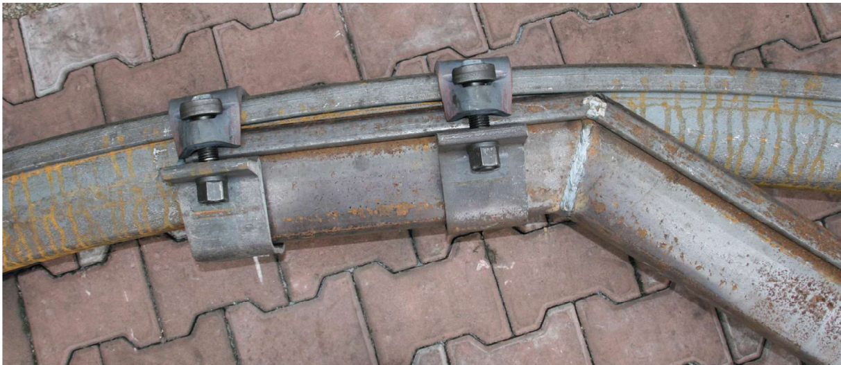
Rys. 8. Połączenie elementu wzmacniającego z łukiem ociosowym odrzwi ŁPSil Fig. 8. Connection of the reinforcing element with the side wall arch of the ŁPSil arch
