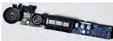
b) Elementy nowego czujnika Kinect związane z akwizycją obrazu RGB-I-D [3]
