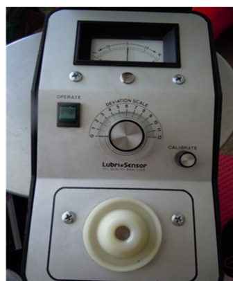
Rys.2. Zestaw do pomiaru stałej dielektrycznej Lubri Sensor [20]
