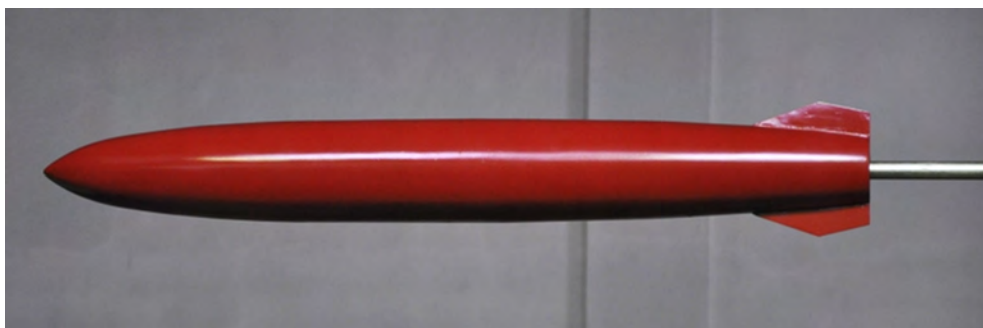
Rys. 2. Model zbiornika paliwa podczas badań charakterystyk podwieszeń izolowanych
