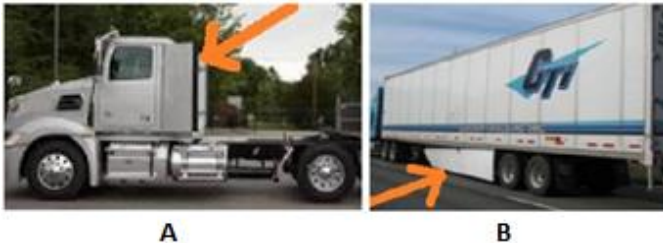
Rys. 2.a - Boczne przedłużenie kabiny [18], b - Osłony między tylnymi i przednimi kołami [19].
