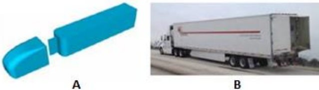
Rys. 3.a - Rozdzielacz [5], b - Pochylone do wewnątrz spojler z tyłu przestrzeni ładunkowej [20].
