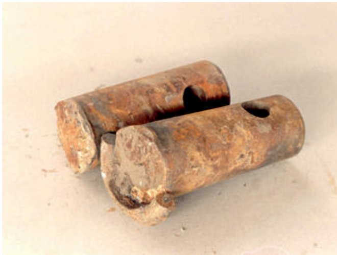
Fig. 7. Exchangeable teeth after breaking the blade parts Rys. 7. Zęby wymienne po wyłamaniu części ostrzowych
