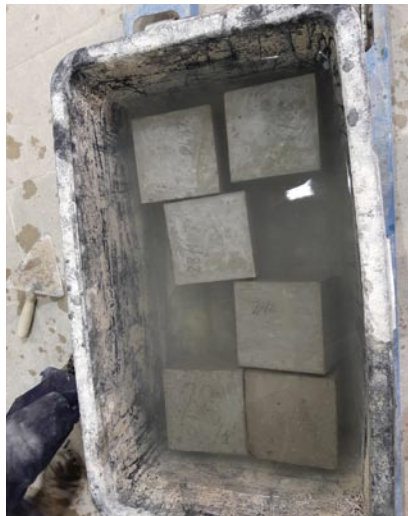
Rys. 7. Pielęgnacja i dojrzewania betonowych próbek
