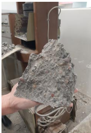
Rys. 13. Próbkę po zniszczeniu
