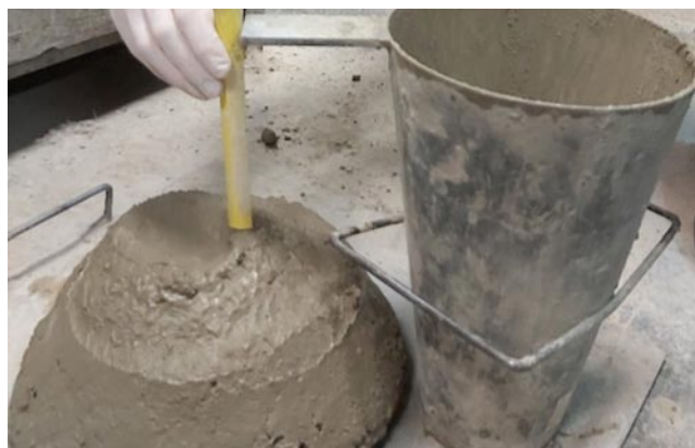
Rys. 5. Badanie metodą opadu stożka według PN-EN 12350-2:2011
