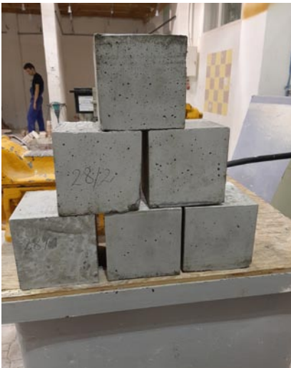
Rys. 6. Próbkę rozformowane przygotowane do pielęgnacji
