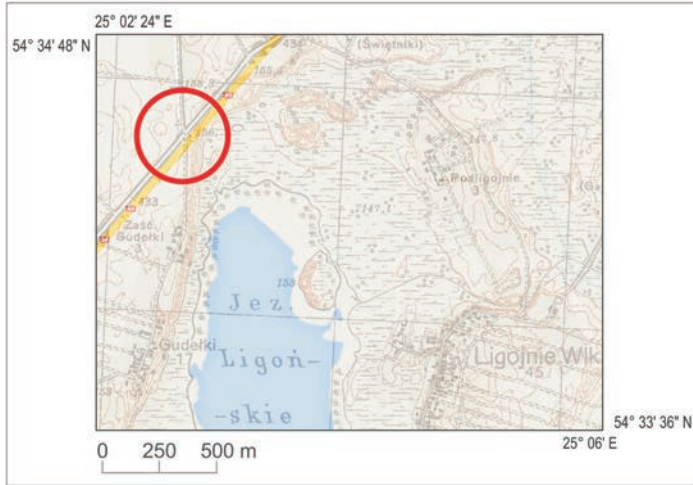
Ryc. 1. Kalibracja arkusza „Skorbuciany” na układ „Borowa Góra”. Kółkiem oznaczono zbieżność przebiegu dróg na kalibrowanej mapie i mapie referencyjnej, co wskazuje na dostateczną jakość kalibracji
