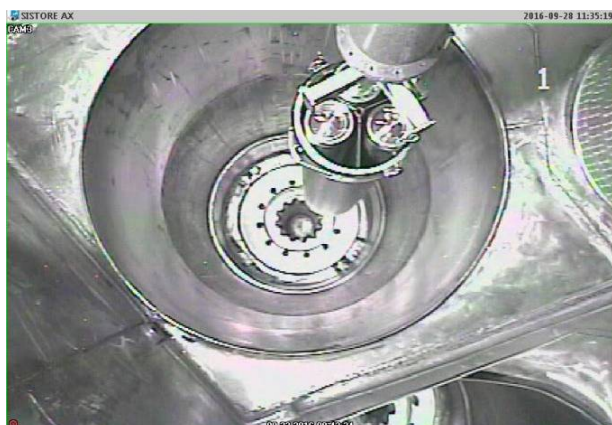
Fot. 1. Operacje prowadzone w komorze demontażowej reaktora: spawanie kapsuły, zawierającej wypaloną sekcję paliwową typu MR, przed załadunkiem i załadunek kapsuł do pojemnika transportowego TUK-19 Phot. 1. Operation carried out inside dismantling hot cell: welding of capsule containing fuel element MR type and loading to TUK-19 cask.
