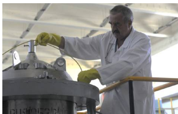
Fot. 2. Transport pojemnika TUK-19, załadowanego wypalonym paliwem, na halę dekontaminacji i sprawdzanie jego szczelności Phot. 2. Transport of TUK-19 cask containing fuel element to the expedition hall and verification of the cask tightness
