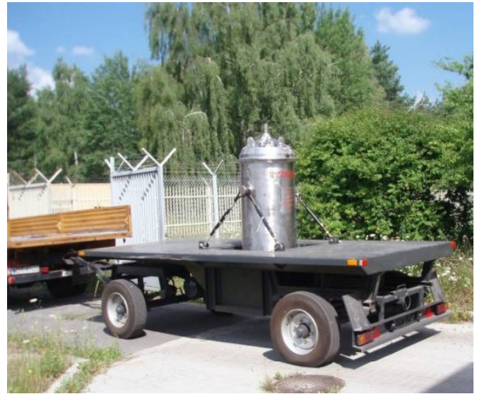
Fot. 3. Pomiary dozymetryczne pojemnika TUK-19 i transport na plac spedycyjny (fot. z archiwum NCBJ) Phot. 3. Dosimetric measurements of TUK-19 cask and transport to expedition area
