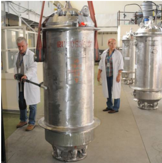
Fot. 3. Pomiary dozymetryczne pojemnika TUK-19 i transport na plac spedycyjny (fot. z archiwum NCBJ) Phot. 3. Dosimetric measurements of TUK-19 cask and transport to expedition area
