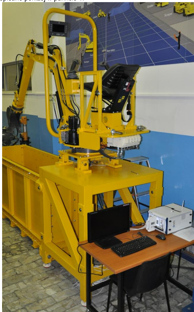
Fot. 1. Symulator koparki jednonaczyniowej w laboratorium Katedry Inżynierii Maszyn Roboczych i Pojazdów Przemysłowych Politechniki Wrocławskiej
