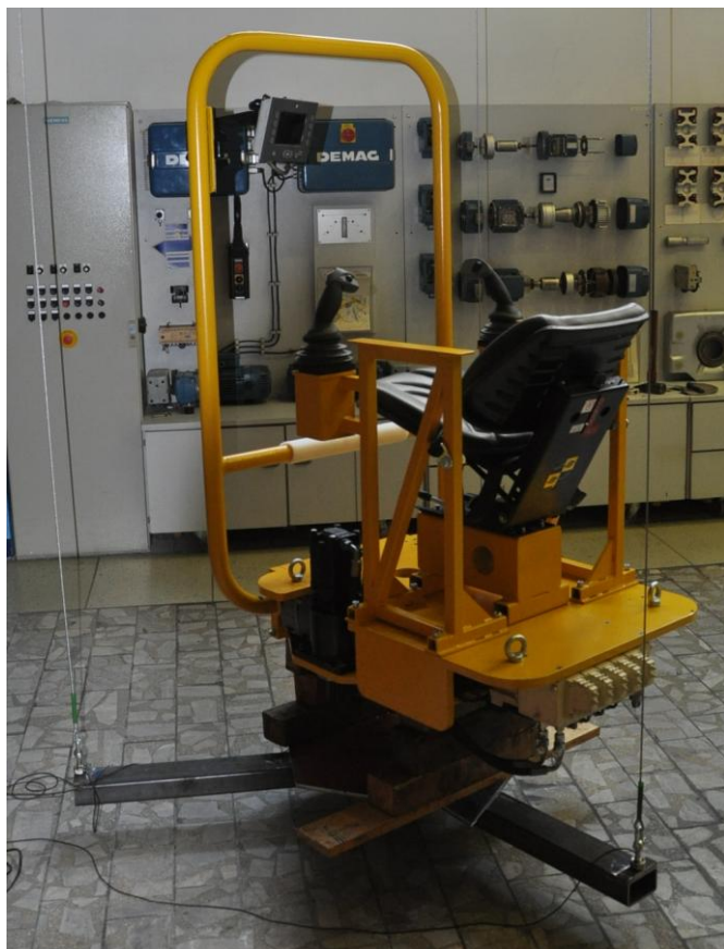
Fot. 3. Nadwozie symulatora koparki w czasie wyznaczania wielkości potrzebnych do określenia momentu bezwładności względem osi pionowej
