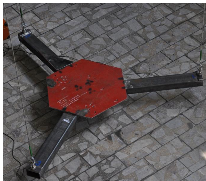
Fot. 2. Zbudowane stanowisko do eksperymentalnego określenia momentów bezwładności
