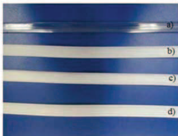
Rys. 1. Wygląd ogólny próbek zawierających mikrosfery polimerowe w ilości: a) 0%, b) 0,25%, c) 0,5% d) 1%
