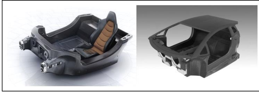
Rys. 4. Monokok wykonany z kompozytu CFRP od lewej w McLarenie, po prawej w Lamborghini [8, 11]
