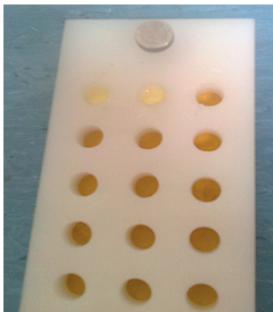
Rys. 1. Forma do nakładania wypełnień stomatologicznych (przed utwardzeniem)
