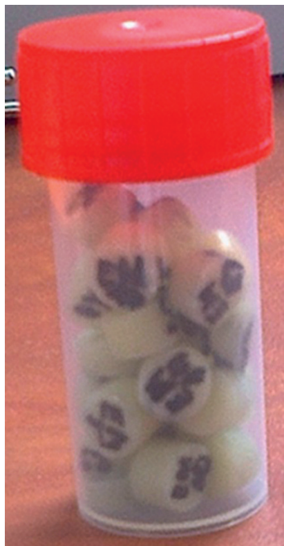
Rys. 3. Wypełnienia stomatologiczne po utwardzeniu i wyjęciu z formy
