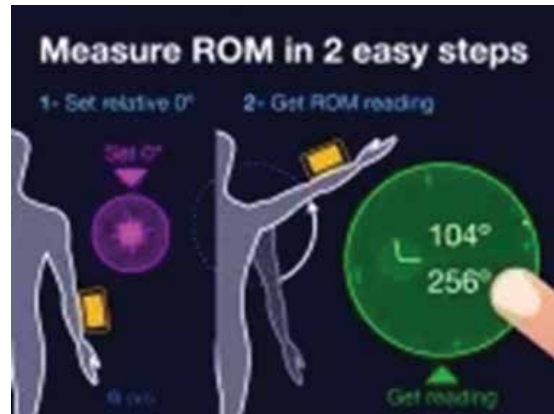
Rysunek 7. Aplikacja Goniometr Pro – ułożenie smartfonu i pomiar
