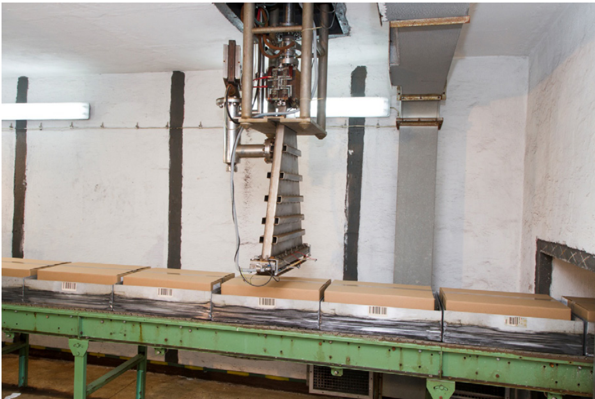
Fot. 1 Akcelerator elektronów przeznaczony do radiacyjnej sterylizacji wyrobów medycznych. Na fotografii widać skaner (końcowa część instalacji akceleratorowej) do przemieszczania wiązki elektronów na szerokość transportera, na którym przesuwają się obrabiane radiacyjnie wyroby Źródło: Archiwum własne.
