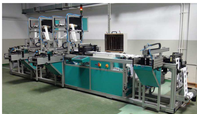
Rys. 3. Linia technologiczna do wytwarzania kart wielowarstwowych Źródło: Kolekcja autora
