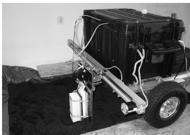
Rys. 5. Realizowany radar w wersji mobilnej Fig. 5. Mobile version of the GPR experimental prototype
