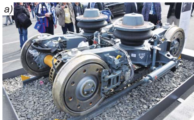
Wózek: a) toczny dla zespołów trakcyjnych (producent – Bombardier), b) z mechanizmem przechyłu nadwozia (producent – Rotem z Korei Płd.) dla zespołów trakcyjnych. Fot. M. Graff
