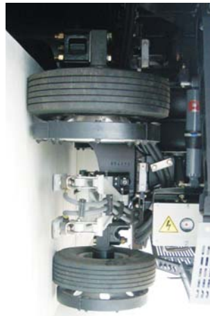
Układ kół w pociągu Innovia. Fot. A. Pomykała
