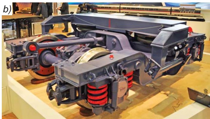
Wózek: a) toczny dla zespołów trakcyjnych (producent – Bombardier), b) z mechanizmem przechyłu nadwozia (producent – Rotem z Korei Płd.) dla zespołów trakcyjnych. Fot. M. Graff
