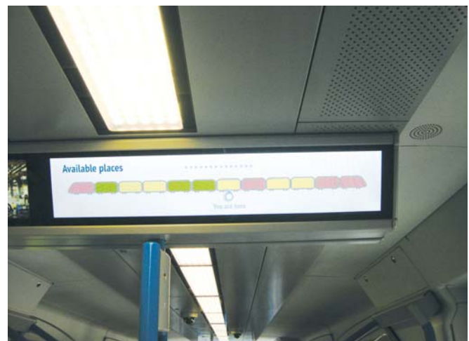
Desiro Thames Link – informator dla pasażerów o zajętości miejsc w pociągu. Fot. A. Pomykała
