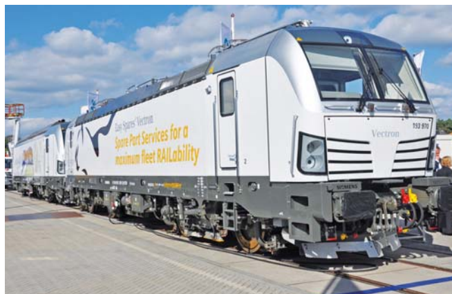
Lokomotywy Vectron: elektryczna i spalinowa (producent – Siemens). Fot. M. Graff
