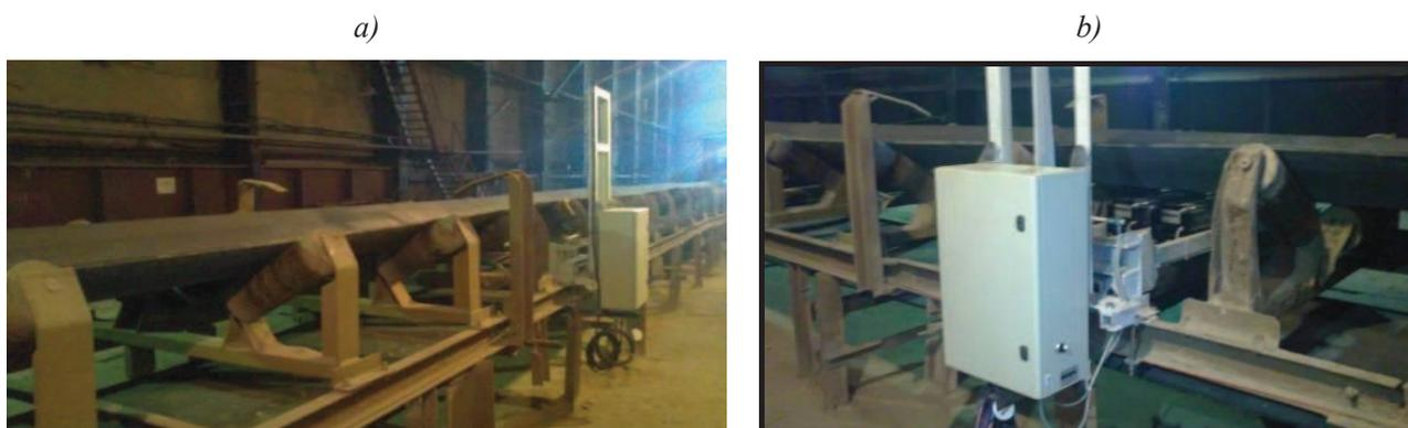
Рис. 13. Система SOLVOS для измерения содержания калия во время эксплуатационных испытаний (собственная разработка)
