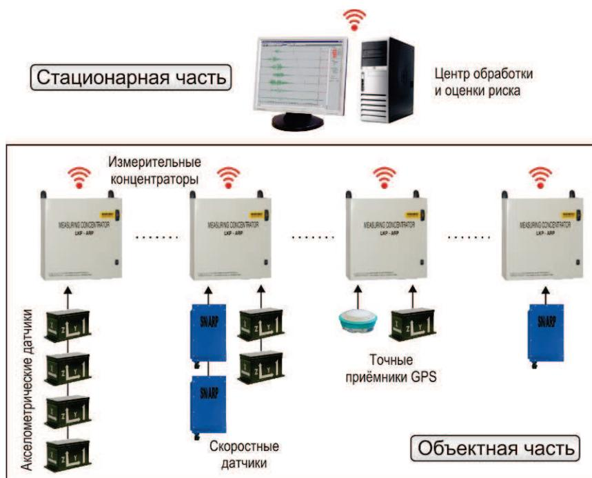
Рис. 2. Аппаратная структура системы ARP2000 P/E с четырьмя измерительными постами (собственная разработка)
