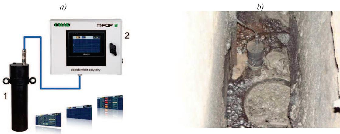
Рис. 14. Золомер MPOF2: а) Общий вид – основные элементы: 1 - измерительная головка, 2 - модуль визуализации, б) вид установленной измерительной головки (собственная разработка)
