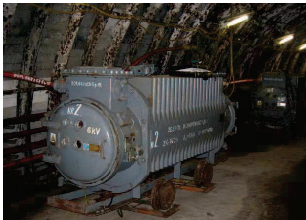
Rys. 11. Widok zespołów kompensacyjnych na stanowiskach pracy: a) typ ZCO; b) typ ZK (opracowanie własne)
