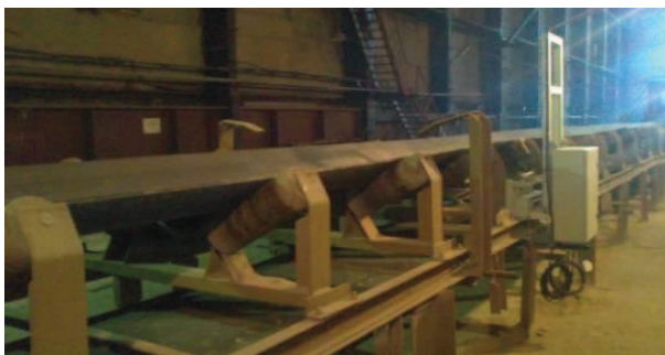
Rys. 13. System SOLVOS do pomiaru zawartości potasu podczas badań eksploatacyjnych (opracowanie własne)
