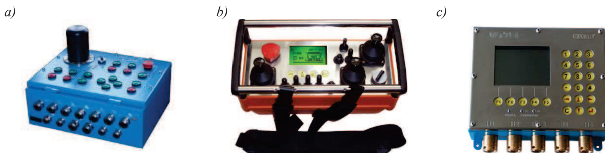
Rys. 3. Elementy SKD-2M: a) panel kontrolno-sterujący PAK-1; b) pulpit radiowego sterowania typu RSO-CH; c) iskrobezpieczny moduł wyświetlacza MLCD-1 (opracowanie własne)
