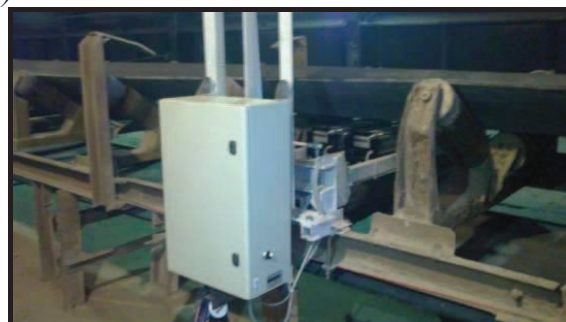
Rys. 13. System SOLVOS do pomiaru zawartości potasu podczas badań eksploatacyjnych (opracowanie własne)
