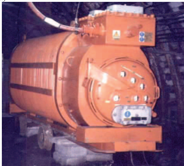
Rys. 11. Widok zespołów kompensacyjnych na stanowiskach pracy: a) typ ZCO; b) typ ZK (opracowanie własne)
