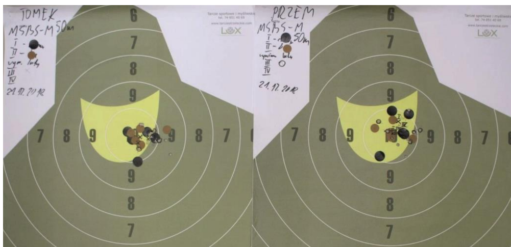
Fot. 2. Przykładowe tarcze na których testowano zmianę ŚPT broni po demontażu i ponownym montażu lufy
