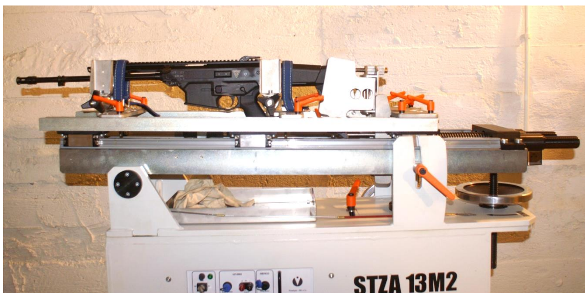
Fot. 3. Karabinek zamontowany na stanowisku badawczym
