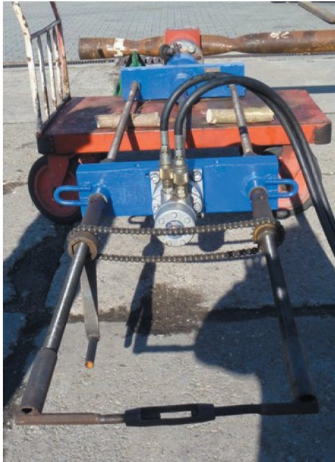
Fig. 7. DN 40 PN 350 hot tapping device
