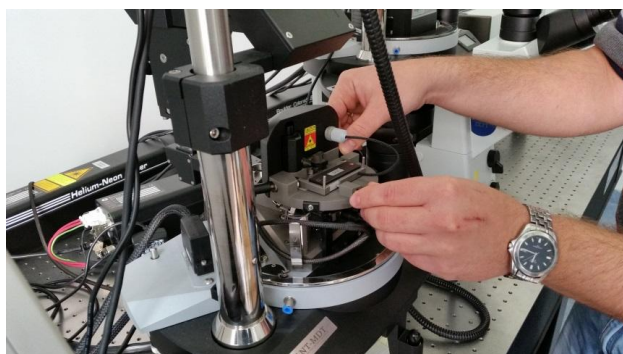
Rys. 4. Przygotowanie głowicy mikroskopu AFM do badań
