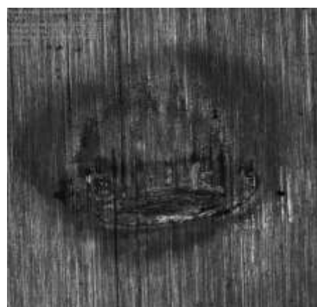
Rys. 8. Zdjęcia mikroskopowe powierzchni próbek stali implantacyjnej 316L po badaniach w środowisku śliny: a) po frettingu (SEM), b) po fretting – korozji (mikroskop konfokalny)
