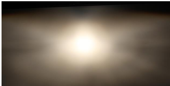
Rys. 2. Strumień świetlny światła drogowego wytwarzany przez żarówkę halogenową HB3
