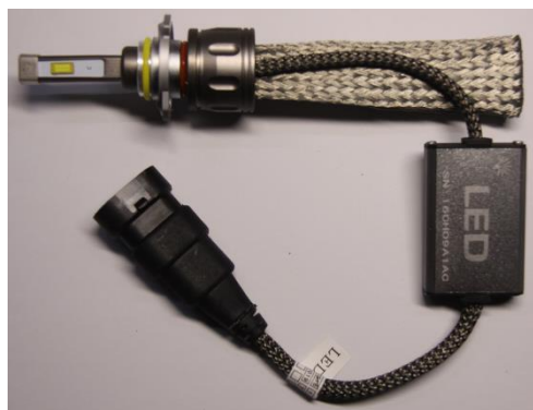
Rys. 4. Zamiennik LED żarówki halogenowej HB3 wykorzystany w badaniach światła mijania i światła drogowego
