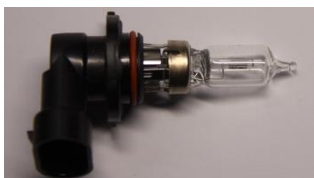
Rys. 3. Żarówka halogenowa HB3 wykorzystana w badaniach światła mijania i drogowego
