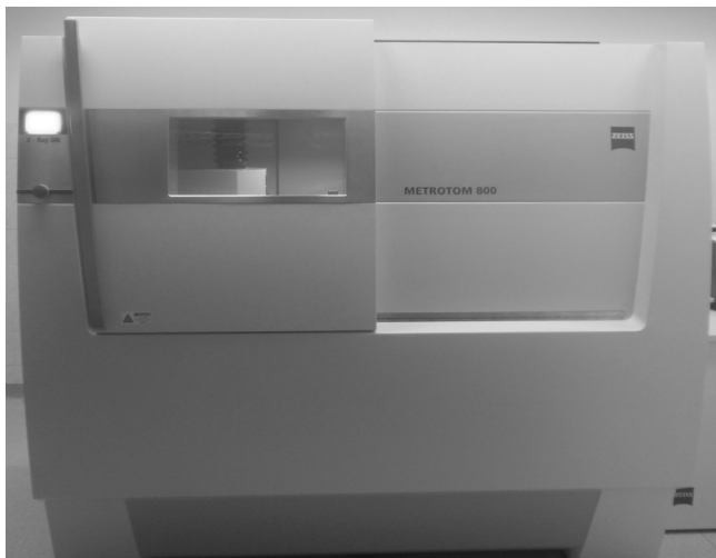
Rys. 1. Przemysłowy tomograf komputerowy METROTOM 800 Fig. 1. Industrial computer tomography scanner METROTOM 800
